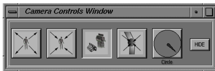
Figura 10.14: Menu de controle interativo da câmera. Da esquerda para a direita: zoom in, zoom out, follow mode, lock joint mode, circle camera.
