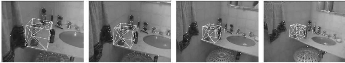
Figura 2. Quadros de um vídeo em que foi aplicado o algoritmo apresentado neste artigo. Os pontos marcados nas imagens foram escolhidos e acompanhados automaticamente pelo algoritmo KLT, sendo utilizados pelo processo de calibração, que estimou as câmeras empregadas na visualização do cubo.
