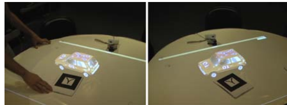
Figura 4. Um marcador é utilizado para mover o carro virtual. Vê-se que a imagem exibida muda conforme o observador se move em relação à mesa.
