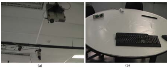
Figura 3. Em (a) o projetor estereoscópico e câmera de vídeo fixados ao teto e em (b) vê-se a mesa, o óculos 3D, o controle do Wii e sua respectiva barra com emissores infravermelhos.
