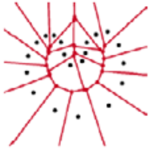
Figura 18 [10]: A figura mostra o diagrama de Voronoi de uma amostragem de pontos S . Da mesma forma que o a amostragem aproxima a curva, os vértices de Voronoi aproximam o "Eixo Medial".
