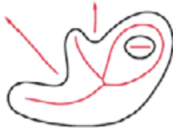
Figura 16 [10]: As curvas de cor mais clara são o "Eixo Medial" da curva em preto.
