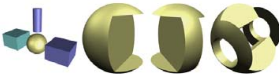
Figura 4 [22] : Três modelos novos foram criados a partir dos quatro iniciais (esfera, cilindro, dois cubos). O primeiro é a esfera menos um cubo, em seguida retirou-se outro cubo e por último retirou-se o cilindro.
