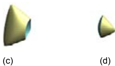
Figura 6 [22]: (a) Dois modelos A e B; (b) Posicionados de forma que A tem uma parte dentro de B, é mostrado o resultado A \cup B: A_f + B_f ; (c) Resultado de A - B: A_f + B_d (d) Resultado de A \cap B: A_d + B_d .
