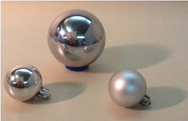
Figura 4. Foram utilizadas esferas espelhadas, esferas difusas e de tamanhos distintos nos experimentos. As pequenas são simplesmente bolas de natal. Observe que a esfera difusa (à direita) reflete uma intensidade menor de luz em comparação com as esferas espelhadas.
