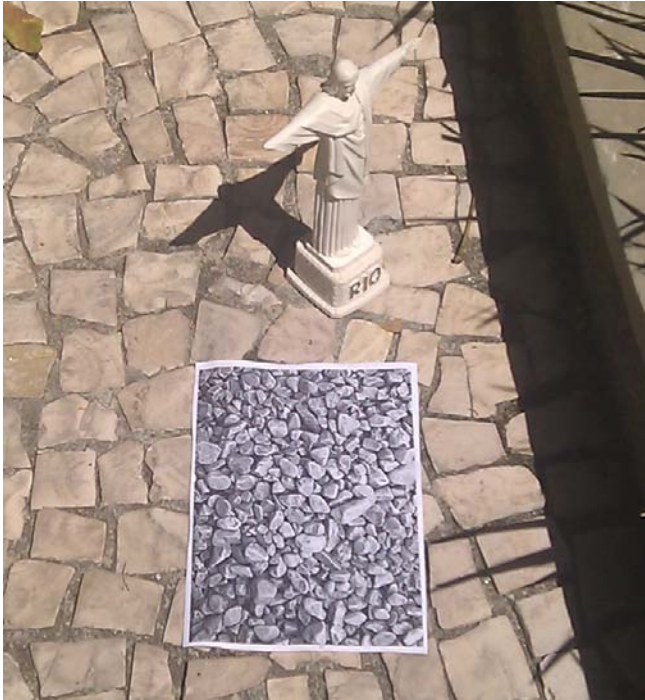
Figura 8. Configuração da cena externa: objeto real e marcador da biblioteca Vuforia AR [17]. Esse marcador não é um fiducial tradicional: é uma imagem que contém muitas altas frequências, pois a biblioteca faz o tracking de Realidade Aumentada analisando os features da imagem em tempo real.
