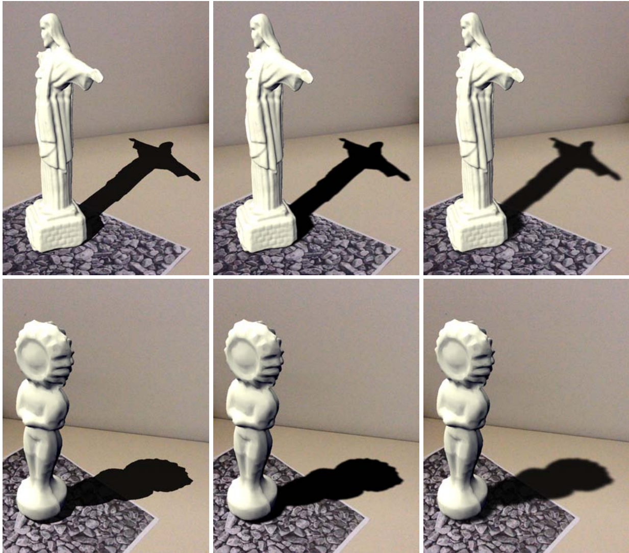
Figura 11. Comparando os três métodos de síntese de sombras descritos: shadow mapping , percentage closer filtering e variance shadow mapping . Nessa comparação, utilizamos no percentage closer filtering um blur de janela 8 \times 8 para mostrar sua eficácia na suavização da sombra e, como esperado, o desempenho foi de 2 FPS. Os demais métodos foram executados em tempo real: o shadow mapping com 32 FPS e o variance shadow mapping com 25 FPS.
