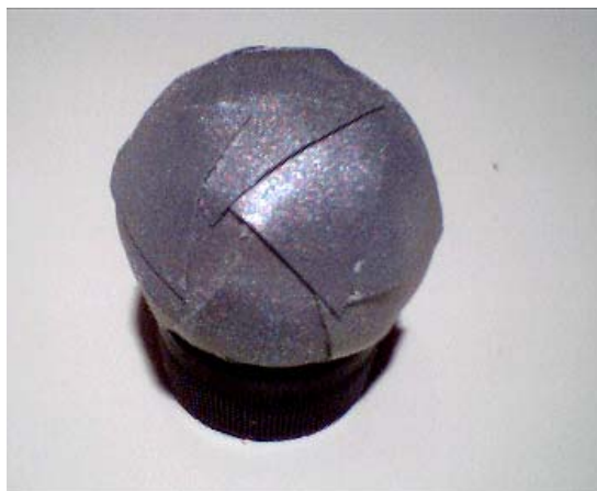
Marcador retrorefletor esférico de alta capacidade (equipamento construído pelo candidato para sua dissertação de mestrado)
